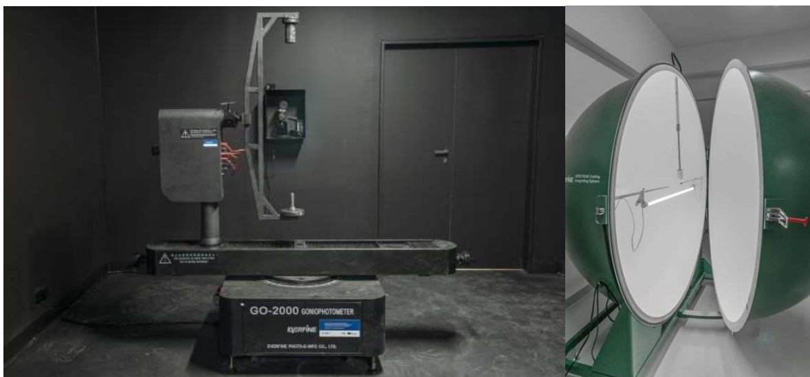
Obrázek č. 4 Výbava fotometrické laboratoře: jasové kamera a Integrační koule
